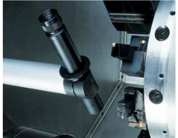
Auch die Werkzeugeinstellung TRAUB ATC gehört zur Grundausstattung.
