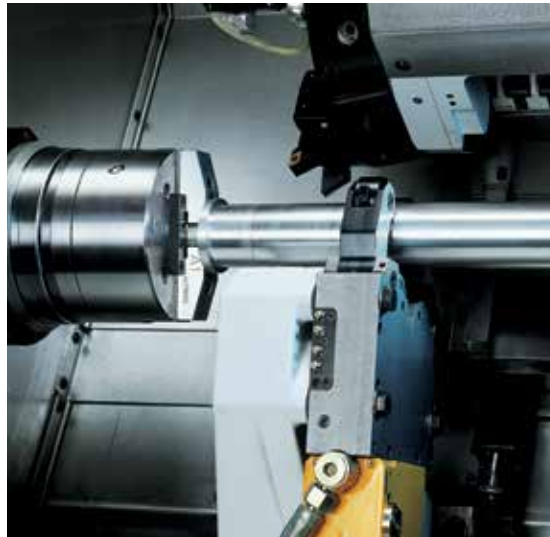
Ob Wellen-, Halbzeug- oder Stangenbearbeitung – die Universalität ist entscheidend. Bild: Lünette feststehend
