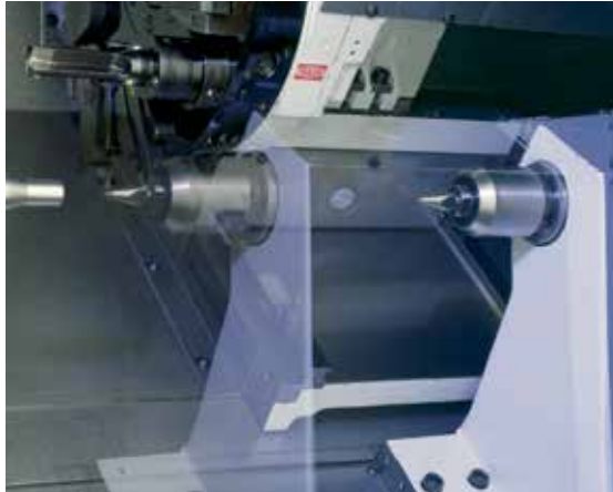
Der Reitstock bietet einen großen automatisch verstellbaren Arbeitsbereich.
