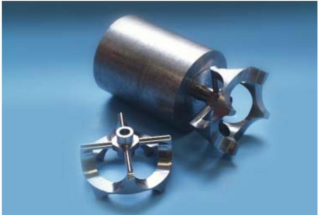
Bild 1: Beispiel für die Verfahrensintegration Drehen, Fräsen und Bohren in der Weichbearbeitung
