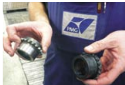
Rechts der induktionsgehärtete Rohling, links das fertigbearbeitete Kettenrad
