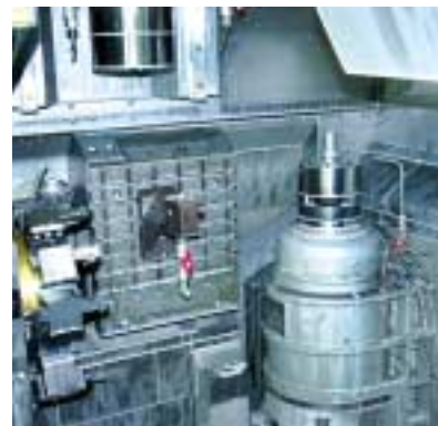
Für Hazet ist wichtig, dass Maßgenauigkeit (liegt bei etwa 0,01 mm) und Oberflächenqualität reproduzierbar innerhalb eines Auftrags erreicht wird.
