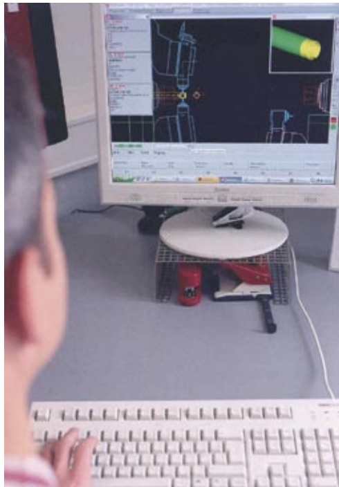
Programmiert wird die ‚TNX80/65‘ bei der Kieselmann GmbH via ‚WinFlex-ITS‘-Software lauffähig und kollisions-geprüft in der AV – das leistungsstarke Programm ist zum Fein-Optimieren aber auch am CNC-Panel verfügbar.
