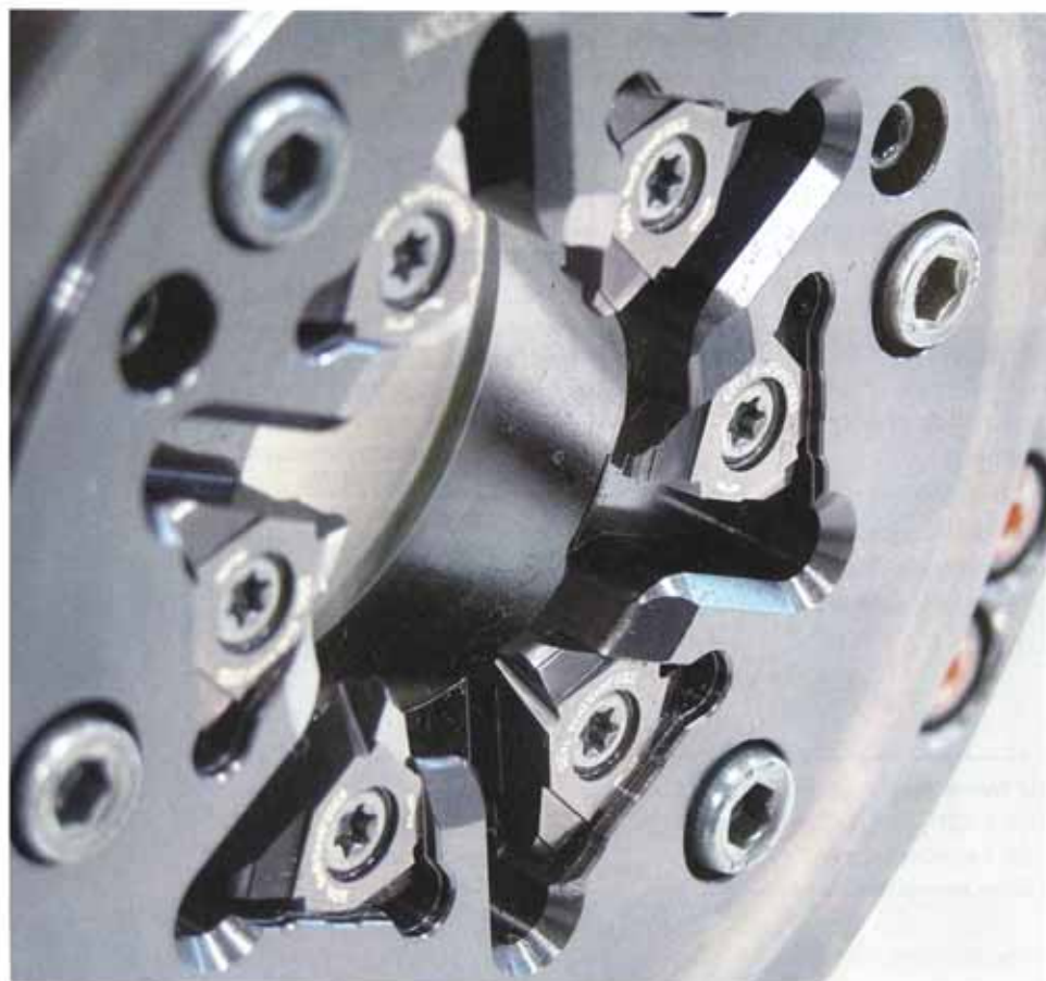
1 Beim Wirbeln sind bis zu sechs Schneiden im Einsatz, die stets einzeln eingreifen und dabei einen sehr weichen Anschnitt gewährleisten
