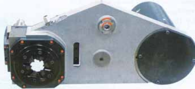
2 Das Ergebnis der langjährigen Zusammenarbeit: Wirbeleinrichtung von Traub (links) mit Wirbelkopf von Horn (rechts), der mit dem Plattensystem 302 ausgerüstet 95 Prozent der Gewindegrößen abdeckt
