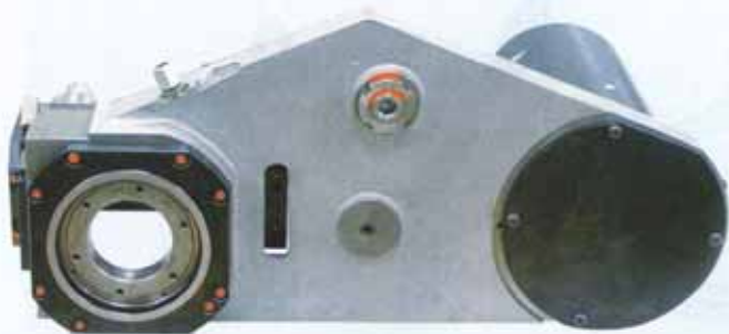
2 Das Ergebnis der langjährigen Zusammenarbeit: Wirbeleinrichtung von Traub (links) mit Wirbelkopf von Horn (rechts), der mit dem Plattensystem 302 ausgerüstet 95 Prozent der Gewindegrößen abdeckt
