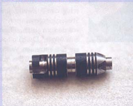
In 54 s fertigt der CNC-Kurzdrehautomat TNL 12K diesen Steuerschieber komplett (Bild: Industrieanzeiger)
