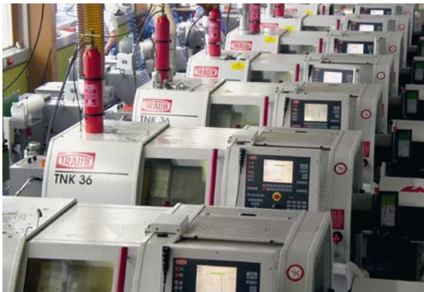
Bild1: Eine schlagkräftige Truppe: In Reih und Glied stehen zehn TRAUB-Kurzdreher vom Typ »TNK36« – die kompakte Anordnung sorgt für kurze Wege bei der Mehrmaschinenbedienung, die beidseitige Zugänglichkeit des Arbeitsraums für kurze Rüstzeiten.
