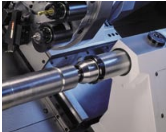
Der sehr robuste Reitstock ist auch mit einer R-Achse lieferbar.
