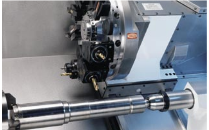
Ein großzügiger Arbeitsraum und ein schnell schaltender Scheibenrevolver mit 12 Werkzeugaufnahmen. Innere Kühlmittelzufuhr und Richtungslogik sind selbstverständlich.
