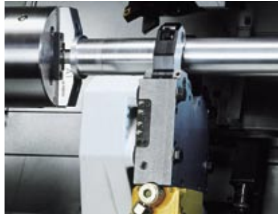
Ob Wellen-, Halbzeug- oder Stangenbearbeitung – die Universalität ist entscheidend. Bild: Lünette feststehend
