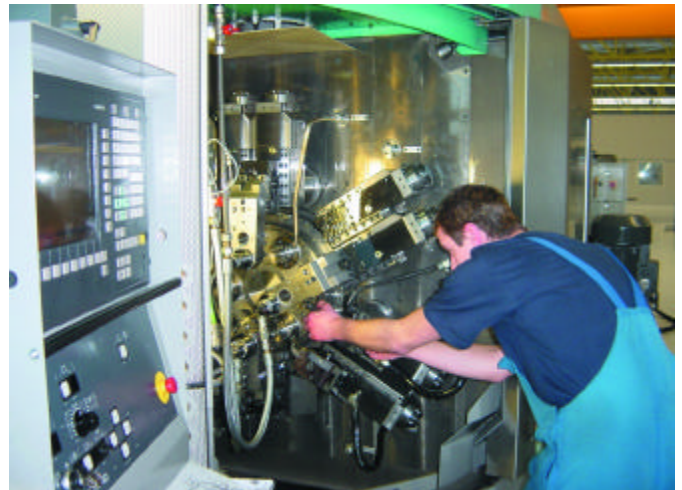
Bisher undenkbar: Tätigkeiten im Arbeitsraum eines Mehrspindlers ganz ohne Verrenkungen
