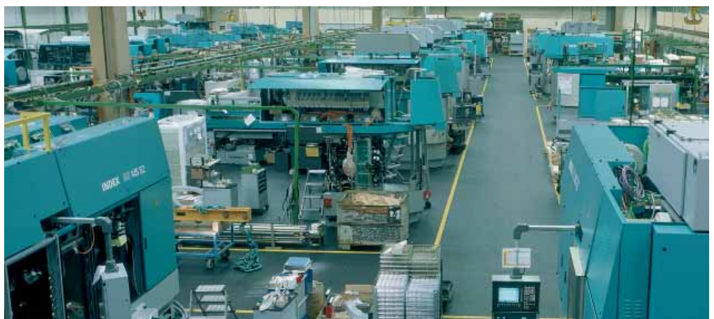
Am Index-Standort Deizisau konzentriert sich die Fertigung und Montage der CNC-Mehrspindeldrehautomaten
