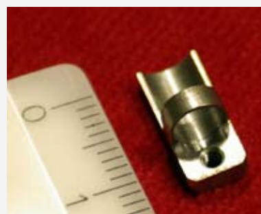
Dieses Teil wird auf einer ABC Maschine aus Rundmaterial 16MnCr5 komplett aus dem Vollen bearbeitet. Alle Kanten müssen durch Fräsen leicht gebrochen sein. Das Loch im Steg hat 0,01mm Toleranz.
