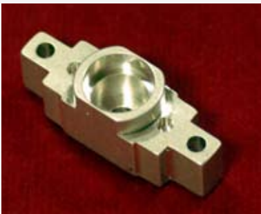
Das Teil aus bleifreiem Aluminium-Profilmaterial wird auf der C100 gefertigt. Der hintere und vordere Durchmesser sind mit 0,008 mm toleriert. Die vordere Bohrungsausdrehung ist mit 0,02 mm toleriert, die hintere Ausdrehung auf der Gegenseite mit 0,009 mm.
