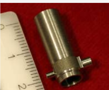
Dieses Teil bestand ursprünglich aus zwei Teilen. Der große Zapfen wurde als Drehteil gefertigt und vom Kunden angeschweißt. Jetzt wird das Teil einschließlich eines zweiten Zapfens auf einer ABC-Maschine komplett gefertigt
