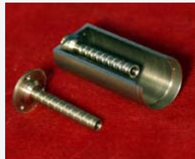
Bei diesem Teil aus Automatenstahl wurden auf der ABC-Maschine fast Unmögliches realisiert. Wandstärke 0,15 mm, Tiefe der Bohrung 29 mm, eine Wendel am Dom (0,06 mm Durchmesser-Toleranz).
