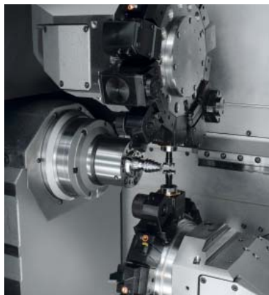
Das Prinzip der beiden gegenüberliegenden Y-Achsen beschert dem Anwender der C100 einen enormen Produktivitätsschub
