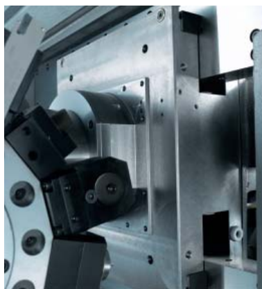
Die Plattenführung INDEX Singleslide setzt bei der C100 neue Maßstäbe in Sachen Dämpfung, Steifigkeit und Werkzeugstandzeiten
