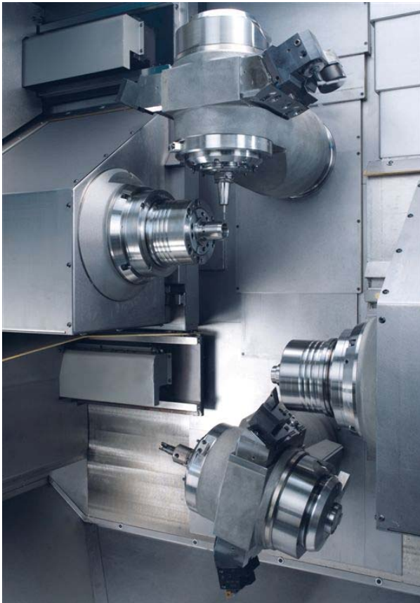
Bild 2 Arbeitsraum der R200: Zwei Arbeitsspindeln, zwei Motor- Frässpindeln in zwei unabhängigen Teilsystemen
