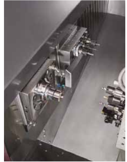
Für mehr Dynamik sorgen flüssigkeitsgekühlte Motorspindeln mit Drehzahlen bis zu 12 000 min -1 .
