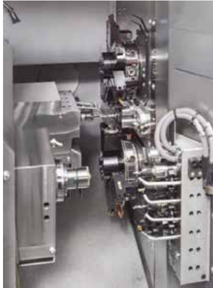
Bei den Werkzeugen, ob in den Revolvern oder bei Front- und Rückapparat, wurden die Getriebezüge minimiert.
