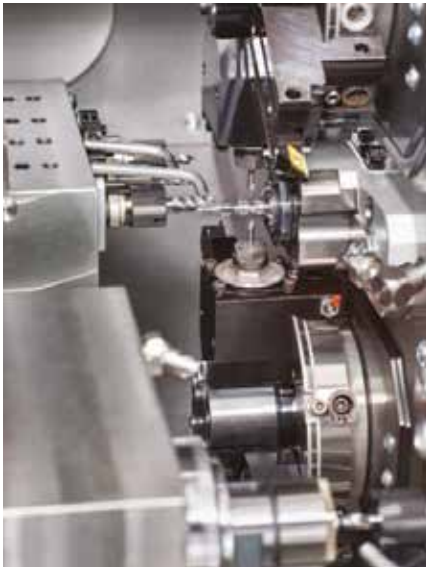
Das Arbeitsraumkonzept: Mit zwei Werkzeugrevolvern sowie einem Front- und Rückapparat simultan und produktiv bearbeiten.
