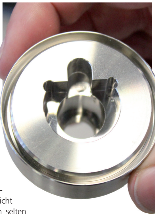
Bild oben: Nach dem Drehen übernehmen angetriebene Werkzeuge in den Revolvern die Fräsbearbeitung, so dass die Bauteile fix und fertig von der Maschine kommen.
