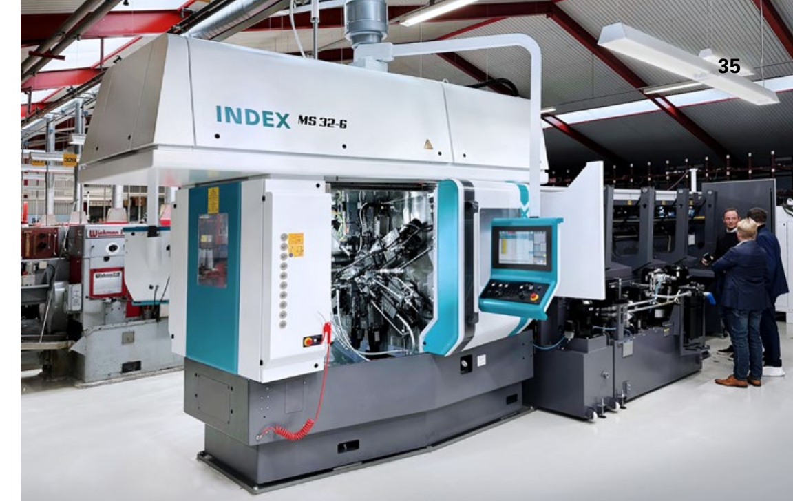
Dernier investissement REA : le nouveau tour multibroches INDEX MS32-6, conçu pour une productivité élevée avec des temps de cycle courts. 750 000 pièces de ces raccords à vis hexagonales sont produites par REA sur cette machine.
