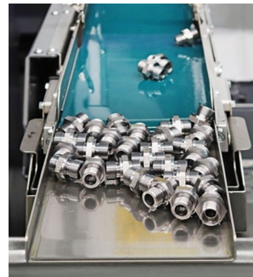
Dernier investissement REA : le nouveau tour multibroches INDEX MS32-6, conçu pour une productivité élevée avec des temps de cycle courts. 750 000 pièces de ces raccords à vis hexagonales sont produites par REA sur cette machine.
