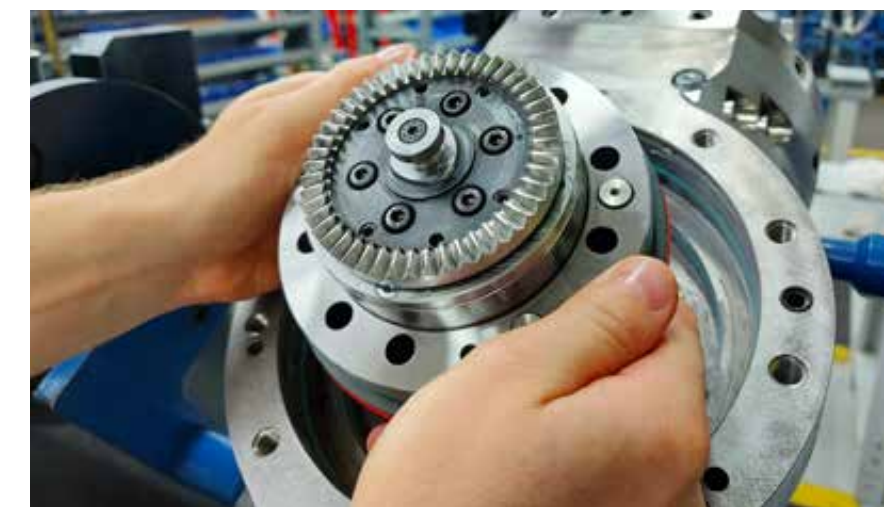
Auch bei Spindelantrieben der INDEX- und TRAUB-Maschinen werden zuverlässige Polygonverbindungen verwendet. Im Bild das 3er-Polygon am Revolverantrieb der INDEX G220.
