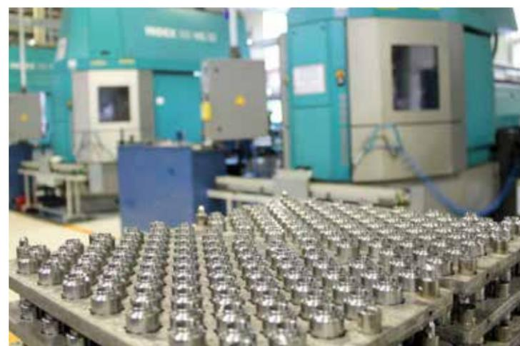
Les machines multibroche d'INDEX déploient leurs atouts en matière de précision et de fiabilité de processus surtout sur les pièces haut de gamme dans des matériaux difficiles à usiner.
