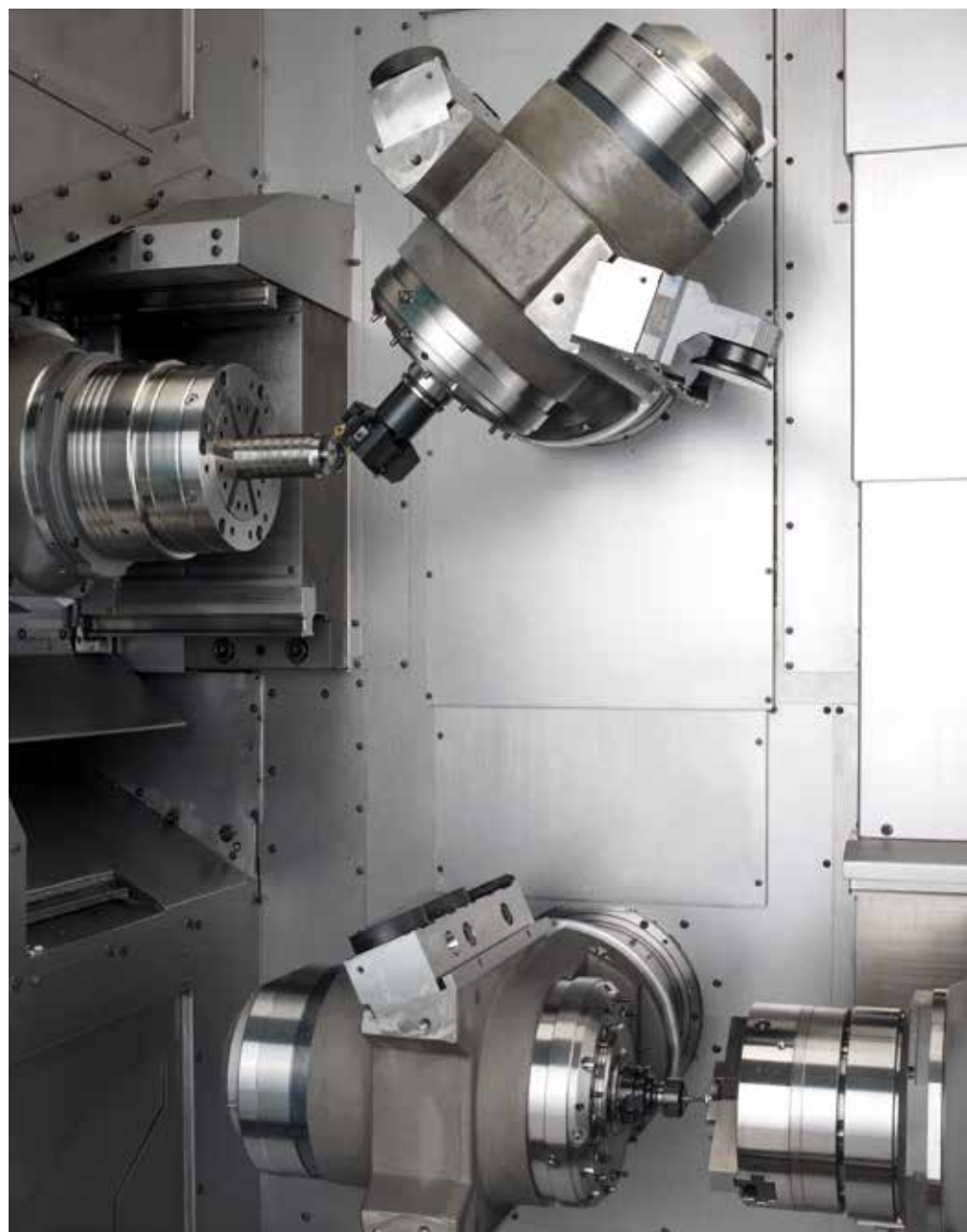
Die Dreh-/Fräszentren INDEX R200 und R300 besitzen eine Haupt- und Gegenspindel. Im Arbeitsraum befinden sich zwei Werkzeugträger, die jeweils über eine Motorfrässpindel verfügen. Durch die Achskonfiguration kann man an beiden Spindeln fünfachsrig bearbeiten.
