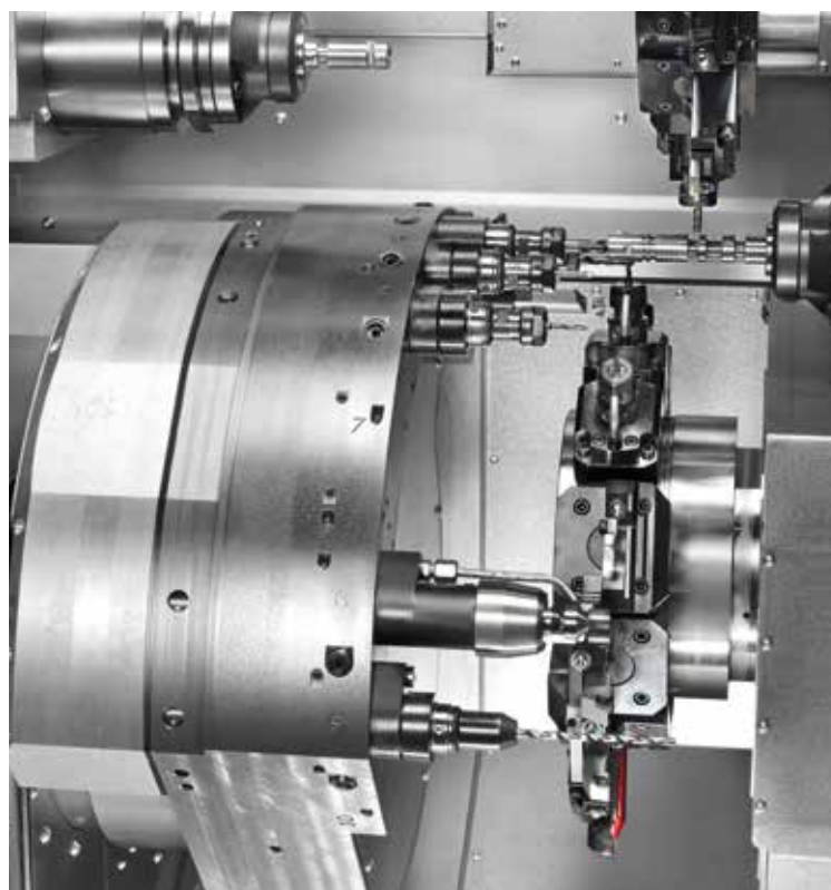
Markantes Merkmal der TRAUB TNL32-11 ist der Frontapparat, der mit 8 Werkzeugstationen, davon 4 angetriebenen, ausgestattet ist.
