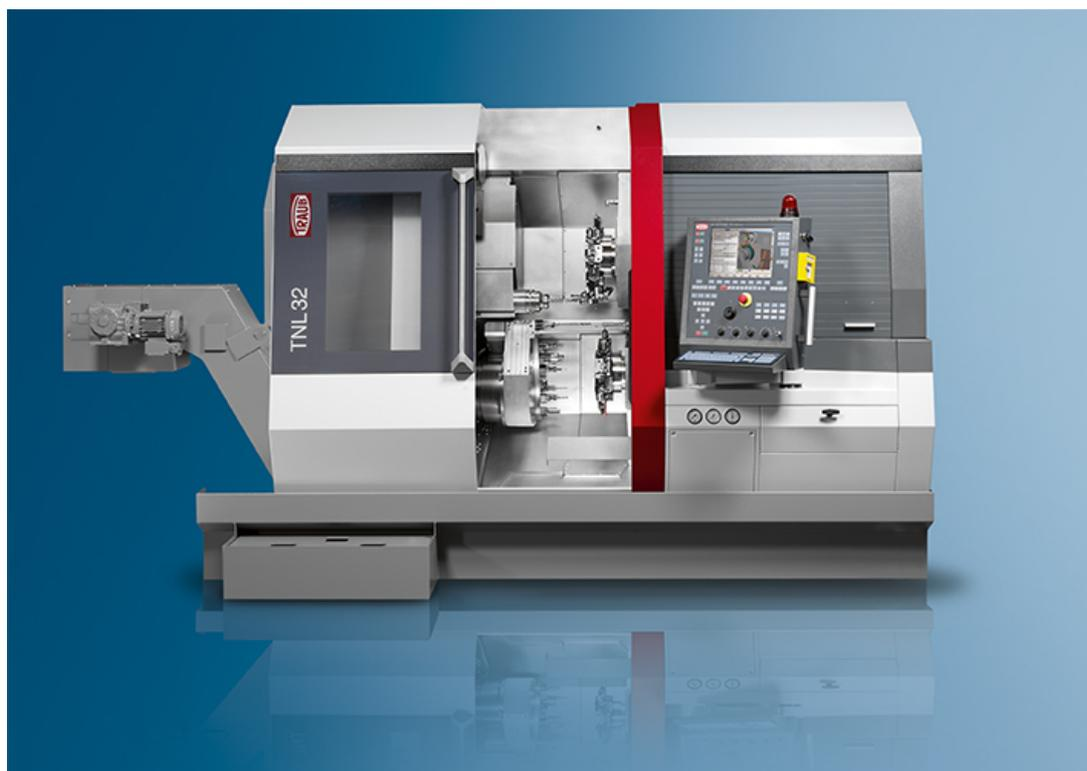
Die TRAUB TNL32-11 ist die neueste Erweiterung der erfolgreichen Lang-/Kurzdrehausomaten-Baureihe TRAUB TNL32. Ihr markantes Kennzeichen ist ein auf einem Kreuzschlitten montierter Frontapparat, der die Zahl der Linearachsen der Maschine auf elf erhöht. So kann die leistungsstarke TRAUB TNL32-11 drei Werkzeuge simultan und doch völlig unabhängig voneinander zum Einsatz bringen. Das spart Bearbeitungszeit – vor allem bei Bauteilen mit hohem Bohranteil.
