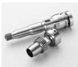
Arbre d'entraînement et pignon d'entraînement Ø20 x 115 mm / X8CrNiS18-9 Ø28 x 60 mm / 11SMnPb30
