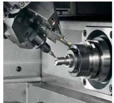
**L'usinage simultané avec deux tourelles outils et dispositif frontal :**
