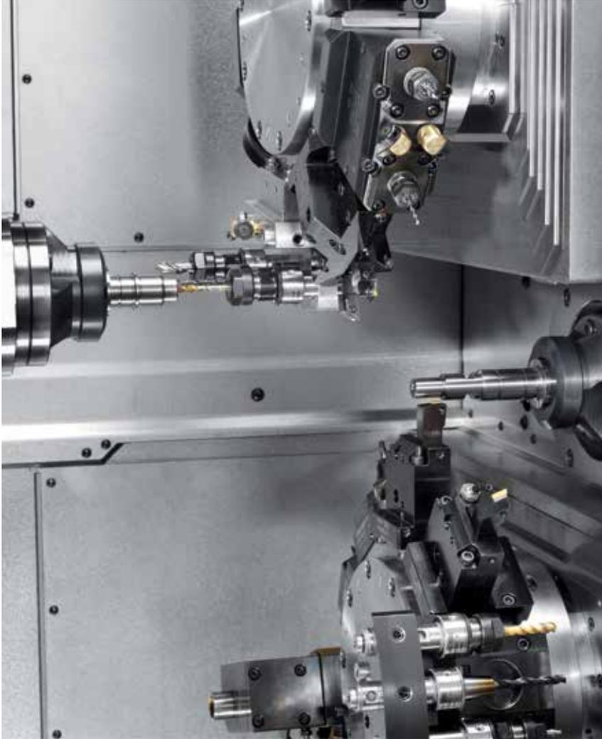
**Cette variante d'équipement du TNL32 dispose d'une contrebroche autonome et de 9 axes numérisés.**
